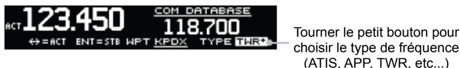
Appuyer sur ENT pour copier la fréquence dans la zone de la fréquence d'attente. Si vous appuyer sur la bascule alors la fréquence passe en fréquence active.
