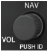
Le bouton Nav Volume/ID contrôle le volume pour le récepteur Nav. Pressez ce bouton et le code morse sera audible, ID apparaîtra à gauche de la fréquence VOR.
