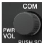
Tournez le bouton dans le sens horaire allume la radio. On l'éteint en tournant dans le sens anti-horaire. Quand la radio (Com) est active, poussez le bouton pour activer/désactiver le squelch.
