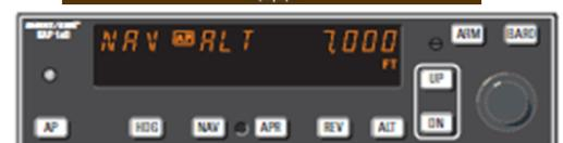
**3. Quand le point de capture calculé est atteint, l'affichage passe du mode HDG au mode NAV et un virage à droite est initié par le PA**
