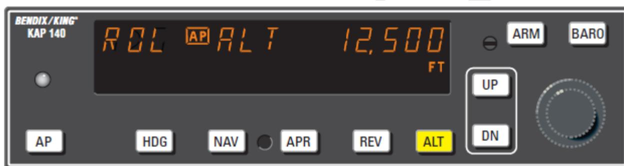
Le mode ALT maintient une altitude pression sélectionnée. Le bouton ALT permet de basculer entre le mode ALT et VS.
