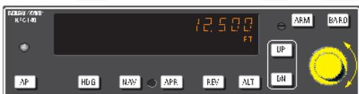
Le signal d'alerte (lumineux et sonore) se déclencherà à 1000ft de l'altitude objectif, et s'éteindra quand l'altitude sera à moins de 200ft de celle ci.
