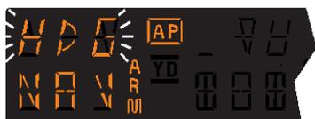
NOTE : quand NAV est sélectionnée, le PA fera clignoter l'afficheur HDG pendant 5 secondes pour rappeler au pilote de réinitialiser la pinnule HDG à la valeur désirée
