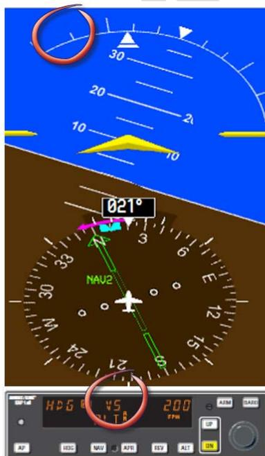
3. Le PA répond à la sélection du mode HDG par un virage à gauche. Le taux de montée a été réduit grâce au bouton DN en préparation à la mise en niveau. La VS sera affichée pendant 3 secondes si nous pressons le bouton DN.
