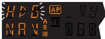
NOTE : quand NAV est sélectionnée, le PA fera clignoter l'afficheur HDG pendant 5 secondes pour rappeler au pilote de réinitialiser la pinnule HDG a la valeur de l'OBS.
