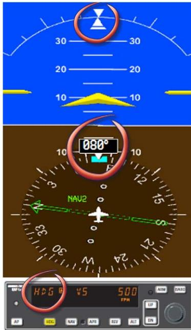
1. L'avion est bien décollé et établi sur un taux de montée sûr. La pinule du HSI (bleue) est réglée sur le cap 080 (QFU). Presser le bouton AP pour enclencher le PA (1/4 de seconde). En pressant le bouton HDG du PA, celui-ci s'engage dans le mode HDG et VS et maintient le cap et le taux de montée actuel.
