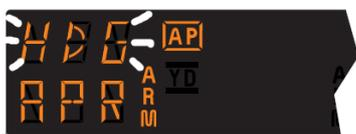
NOTE : quand ARM est sélectionnée, le PA fera clignoter l'afficheur HDG pendant 5 secondes pour rappeler au pilote de réinitialiser la pinnule HDG à la valeur désirée
