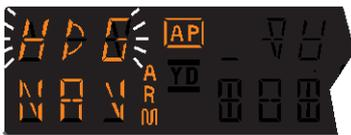
**NOTE : quand NAV est sélectionnée, le PA fera clignoter l'afficheur HDG pendant 5 secondes pour rappeler au pilote de réinitialiser la pinnule HDG à la valeur de l'OBS.**
